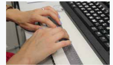
BRAILLEZEILE: COMPUTERAUSGABEBERÄT, DAS ZEICHEN IN BLINDENSCHRIFT ÜBERSETZT
