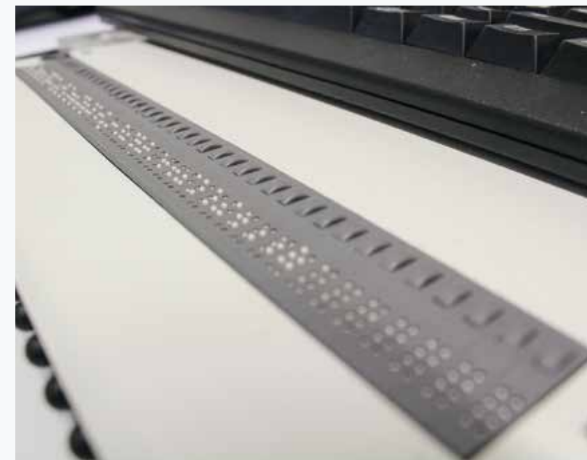
BRAILLEZEILE: COMPUTERAUSGABEBERÄT, DAS ZEICHEN IN BLINDENSCHRIFT ÜBERSETZT
